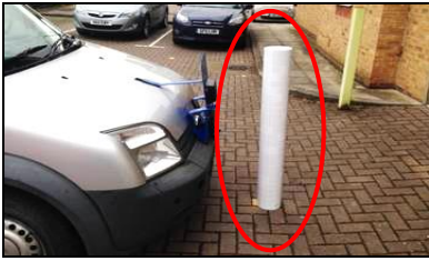
0,6 metrede takılı bir kameranın önündeki 1 metre uzunluğunda direk
